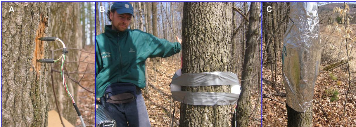
**Figure 4.** A : Installation de la sonde côté sud de l'arbre. B : Fixation des deux sondes Nord et Sud sur l'arbre. C : Mise en place de l'isolant thermique autour du tronc.
