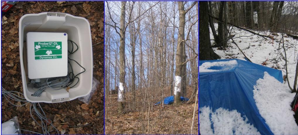
**Figure 5.** Station d'enregistrement des données. Une caisse isolante et une bâche de protection permettent de laisser la station en permanence sur le terrain.
