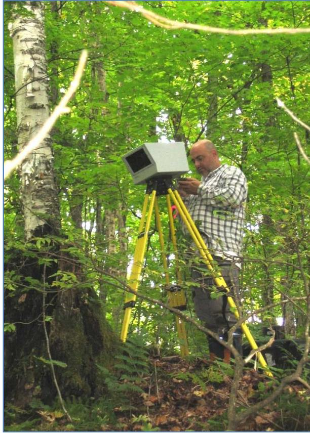
**Figure 3.** Prise d'un scan au LiDAR terrestre avec un ILRIS 3D (OPTECH) pendant la première de mesure (i.e. avant la chute des feuilles).
