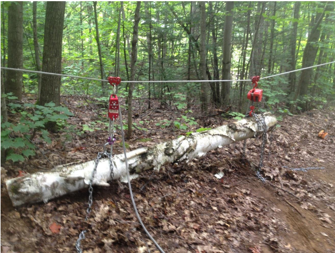
Figure 7: Démonstration de deux outils pour soulever un billot sur la tyrolienne. À gauche, la poulie auto-bloquante et à droite, le palan à chaîne
