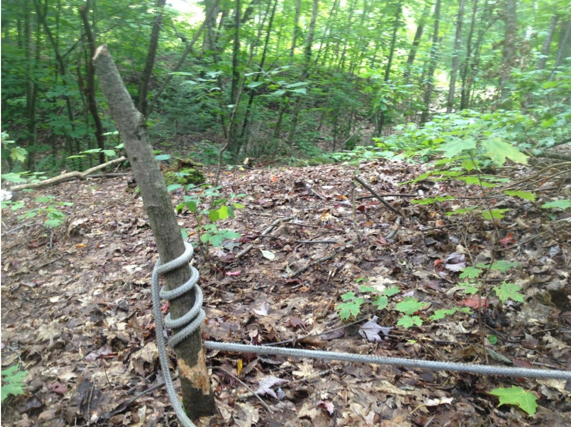
Figure 9: Démonstration de l'utilisation d'une gaule tronquée pour ralentir la descente d'un billot. À droite, le câble est attaché au billot monté sur la tyrolienne. C'est par ce nœud de friction que le billot est retenu. En tirant vers le haut, le nœud se défait graduellement.
