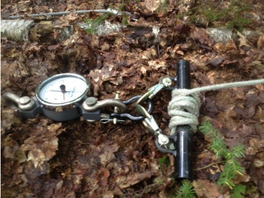
Figure 3: Démonstration du joint entre le tensiomètre et le joint de câbles
