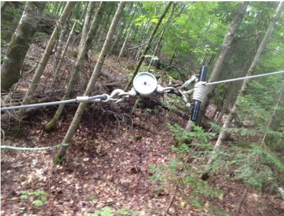
Figure 4: Démonstration du lien entre le câble du Sumo, du tensiomètre et du câble de la tyrolienne
