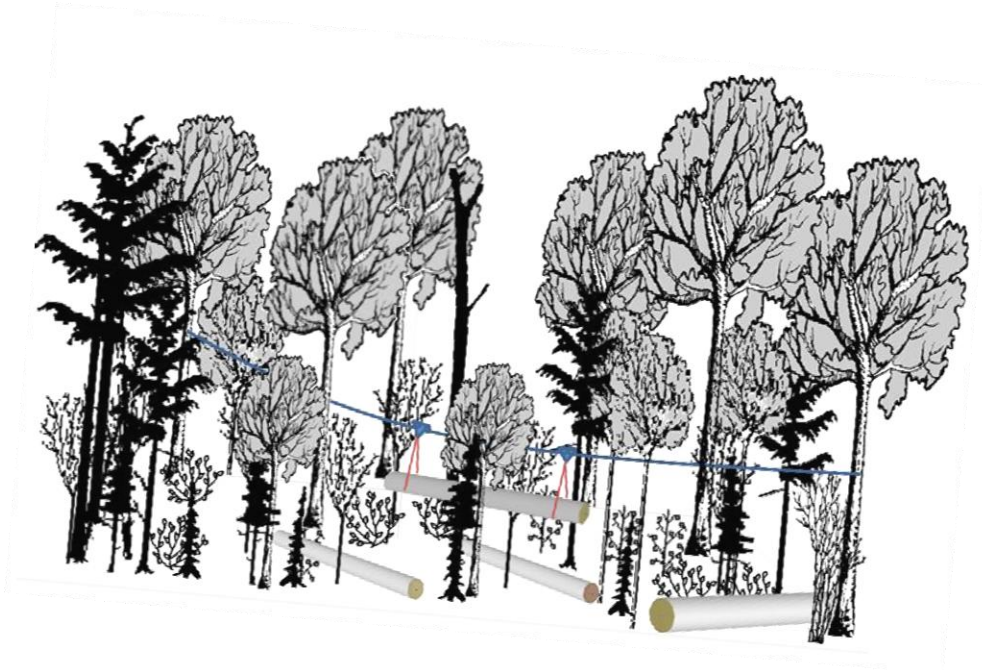
Figure 1: Illustration de l'utilisation de la tyrolienne pour extraire les billots du peuplement forestier.
