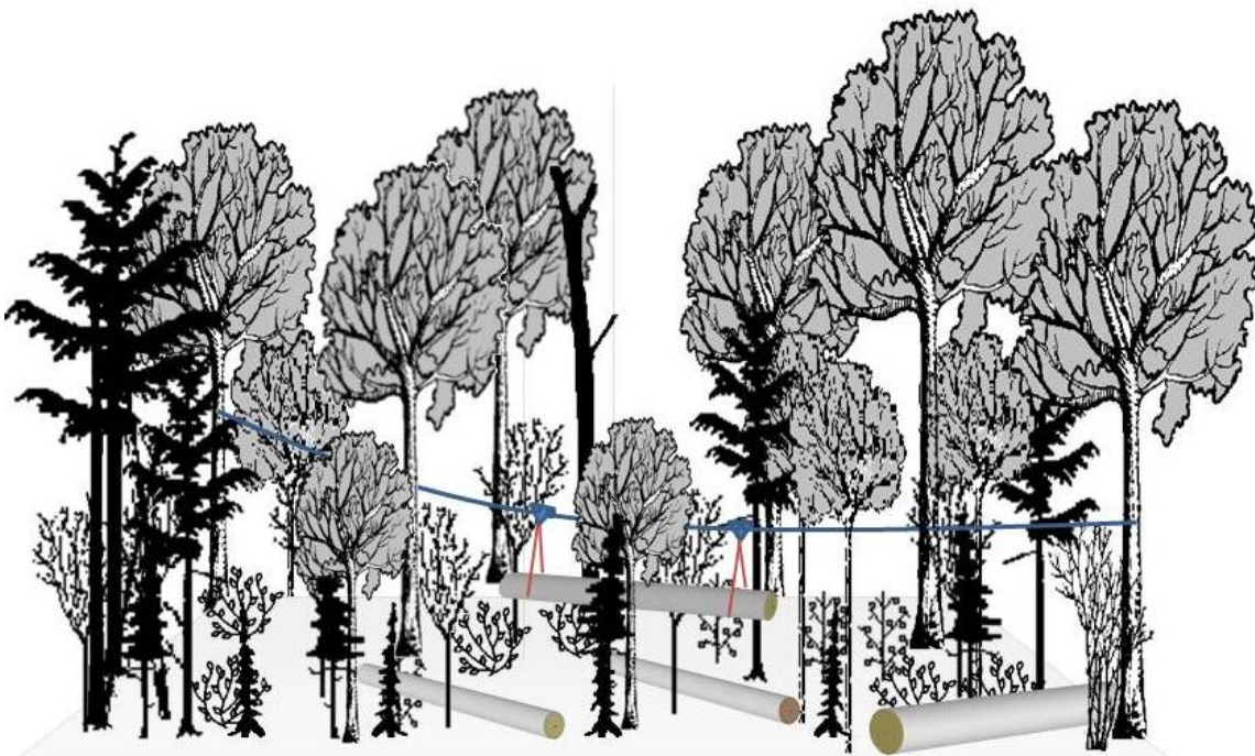
Figure 2 : Illustration de l'utilisation de la tyrolienne pour extraire les billots du peuplement forestier.
